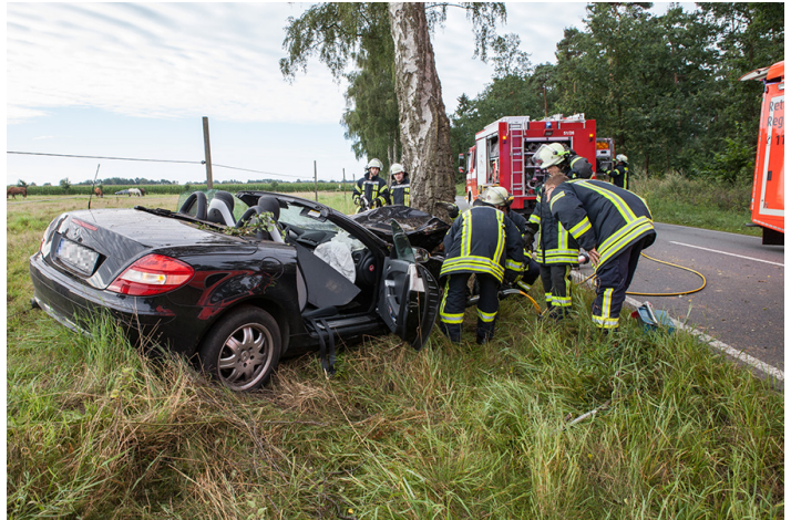
Die Einsatzkräfte der Feuerwehr mussten die Motorhaube mit hydraulischen Gerät öffnen, um die Batterie abzuklemmen.
