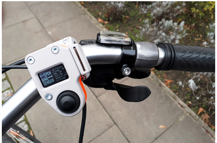
Mit dem OpenBikeSensor wird der Abstand gemessen.
